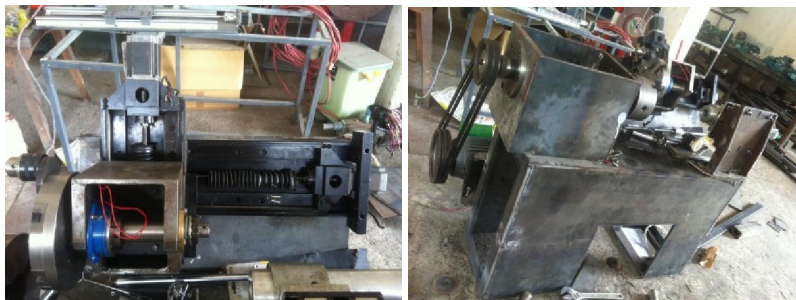
Hình 9. Cụm bàn dao và cụm trục chính
