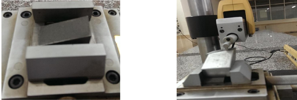
Hình 7. Hình ảnh gá mẫu trên máy đo độ nhám a) Vị trí căn đệm trên bàn máy b) Hình ảnh đo độ nhám
