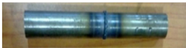
Hình 4. Mẫu mối hàn sau khi hàn thực nghiệm
