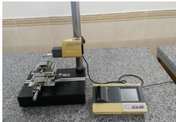
Hình 3. Máy đo nhám Mitutoyo SJ - 400
