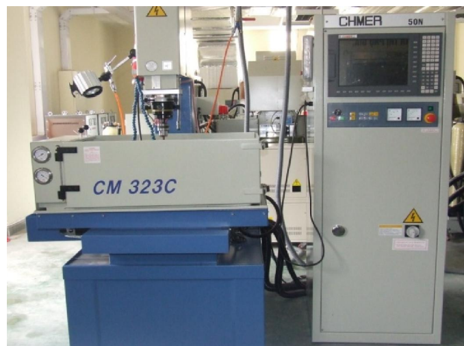
Hình 1. Máy gia công xung điện CHMER CM323C
