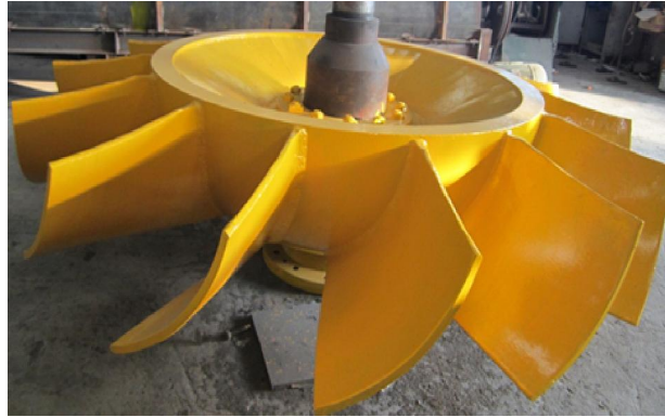
Hình 2. Cánh quạt khói bụi công nghiệp tại Nhà máy nhiệt điện Quảng Ninh
