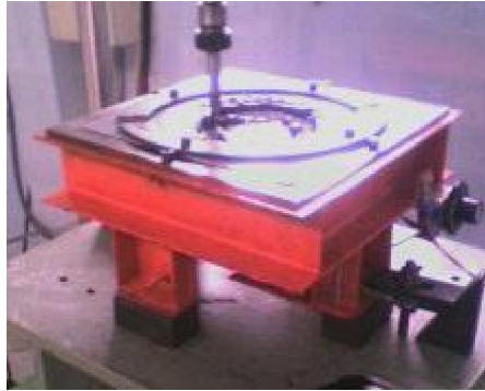
Hình 3. Các thành phần của qui trình ISF để tạo hình tấm nhựa PVC
