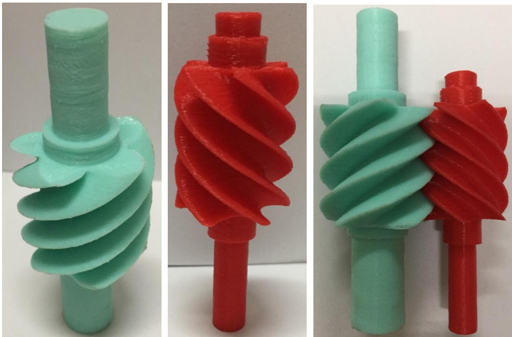
Hình 10. Cặp rotor trục vít trong máy nén sau khi in
