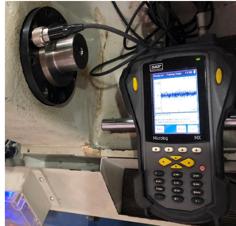
Hình 7. Thiết bị đo và phân tích rung động CMX-A44 của hãng SKF
