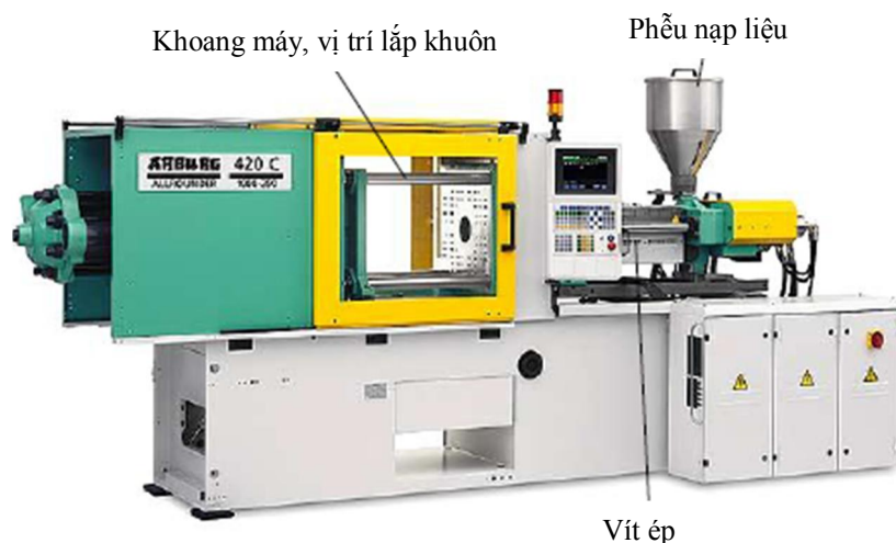
Hình 1. Máy ép nhựa kiểu vít ép
