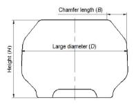
**Fig. 3.** Design parameters for 2<sup>nd</sup> preform
