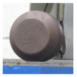
Fig. 10. Optimal preform
