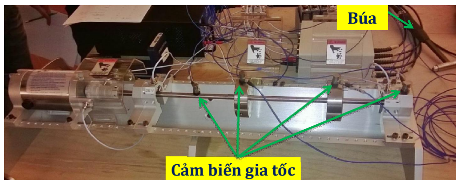
Hình 1. Bàn thí nghiệm được sử dụng để xác định tần số riêng bằng kiểm tra và đập
