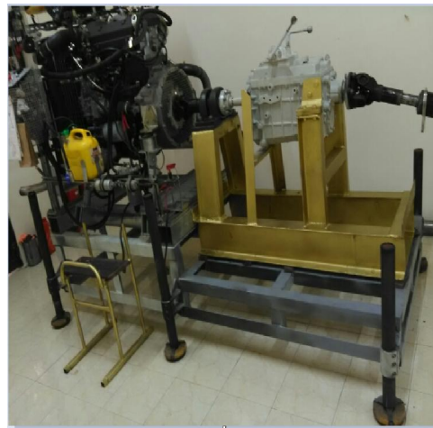
Hình 8. Giá đỡ động cơ diesel IVECO 81kW và hộp số tay 5 số
