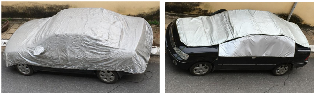
Hình 2. Thực nghiệm đo nhiệt độ trong xe khi sử dụng bạt thương mại và bạt cao su xốp
