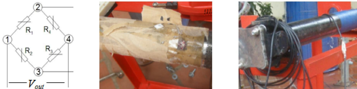
Hình 4. Mạch cầu Wheatstone và dán tenzo lên bán trục cầu sau
