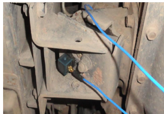
b) Lắp cảm biến đo dao động ụ đỡ treo hộp số
