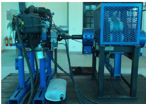
a) Bộ thử HTTL dòng công suất hồ
