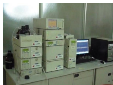
Hình 5. Máy đo sắc ký lỏng hiệu năng cao mã RID - 10A ( Nhật Bản)
