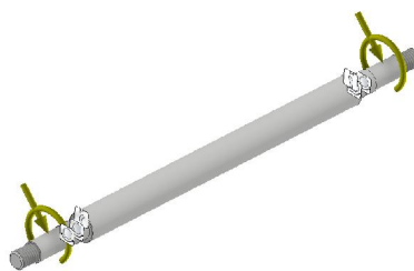
Hình 16. Chọn mặt cố định và đặt lực lên trục
