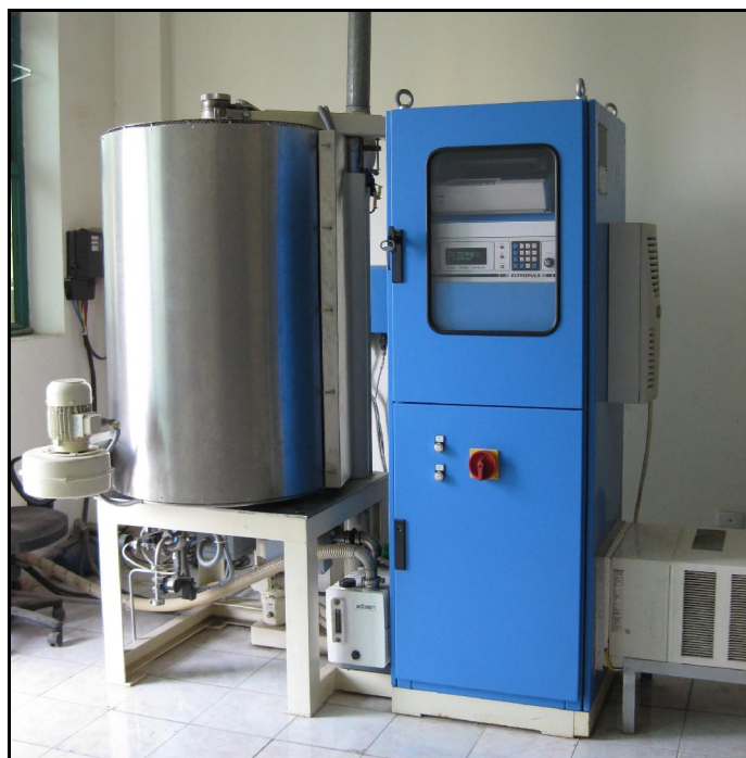
Hình 1. Thiết bị thấm nitơ plasma Eltropuls
