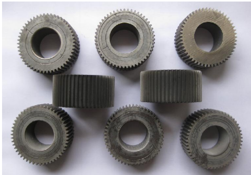
Hình 9. Bánh răng trong lắp trong máy in Offset 4 màu Daiya của hãng Mitsubishi
