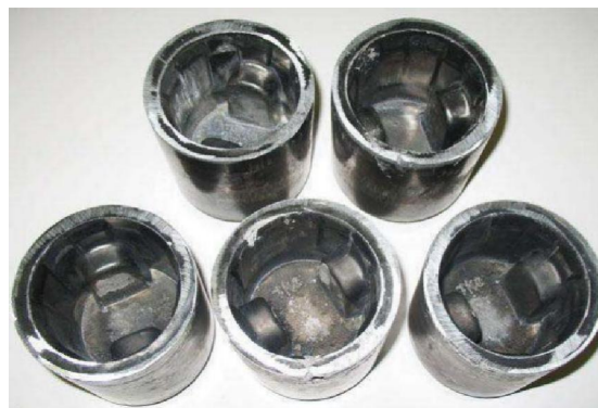
Hình 4. Mẫu phôi piston máy nén khí ДПЦ-85
