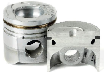
Hình 3. Piston sau khi xử lý qua FSW (cấu trúc tế vi của piston đã được cải thiện đáng kể)
