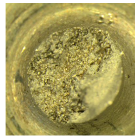
Hình 7. Cấu trúc tế vi (a) và bề mặt chỗ đứt (b) của mẫu №1 sau khi thực hiện FSW và thử kéo
