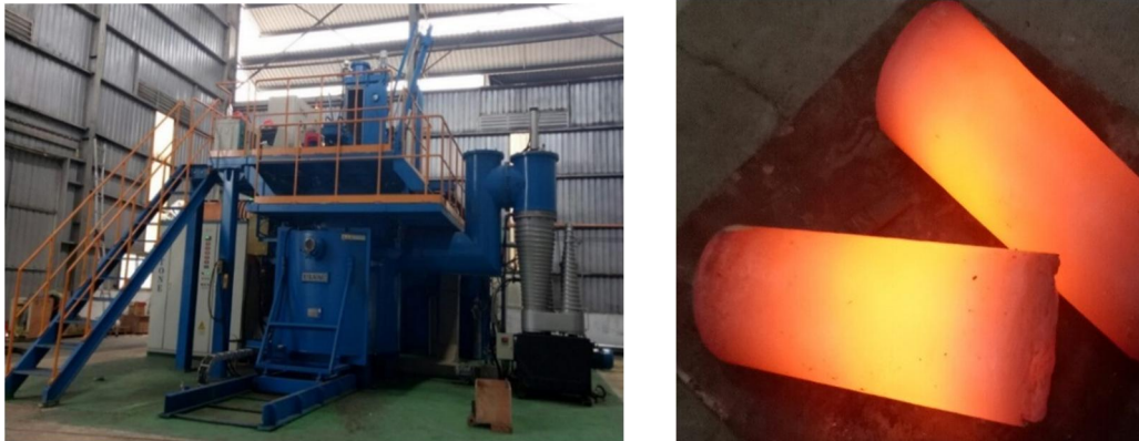
Hình 3. Lò VIM 300kg của công ty Mirex và phôi thép đúc chân không trong lò
