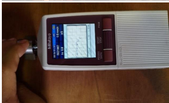
Hình 2. Thiết bị thí nghiệm (máy xung EDM EXPRESS của Đài Loan) và thiết bị đo (SURFTEST SJ-210 của Nhật Bản)
