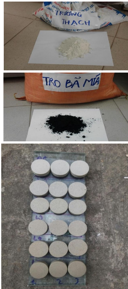
Hình 3. Nguyên liệu chế tạo gạch và sản phẩm gạch sau khi nung
