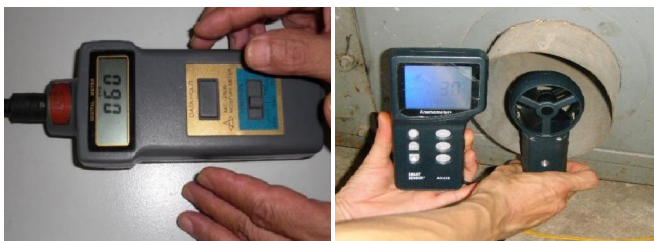
a) Máy đo độ ẩm long nhãn MC-7805 b) Máy đo tốc độ gió SMART-SENSOR
