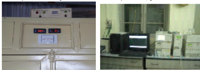
c) Thiết bị đo độ ẩm và nhiệt độ trong buồng sấy d) Máy đo sắc ký lỏng RID-10A
