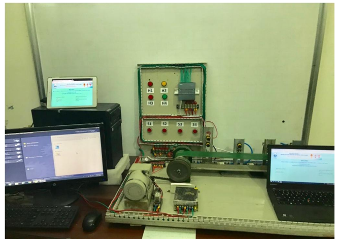
Hình 12. Mô hình điều khiển và giám sát hệ thống ứng dụng PLC S7-1200 tại khoa Điện, Trường Đại học Kinh tế - Kỹ thuật Công nghiệp
