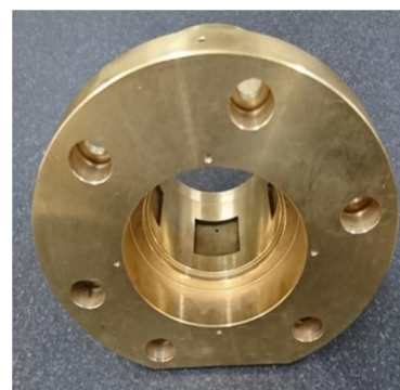
Hình 6. Kết cấu cụm ổ trục chính thủy tĩnh máy mài tròn ngoài 3K12
