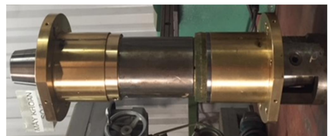
Hình 7. Bạc và cụm ổ thủy tĩnh sau khi chế tạo
