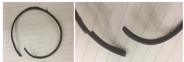
Hình 6. Gioăng cao su bị gãy trong quá trình kéo phôi vào lòng cối
