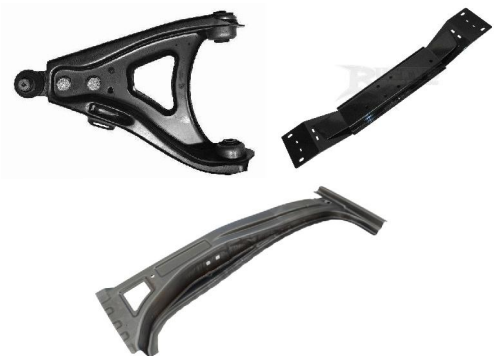
Hình 2. Một số chi tiết của ô tô được dập bằng phương pháp dập thủy tĩnh
