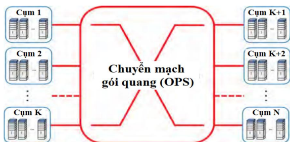
Hình 1. Sơ đồ hệ thống DCN sử dụng OPS
