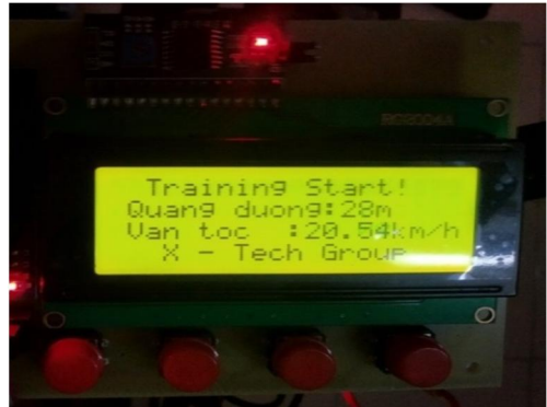
Hình 6. Màn hình hiển thị chỉ số về vận tốc và quãng đường đang thực hiện
