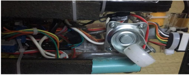
Hình 3. Hệ thống di chuyển dùng bánh điều hướng
