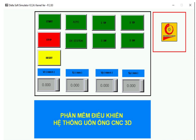
Hình 7. Giao diện điều khiển
