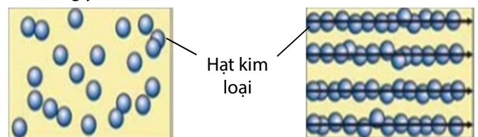
Hình 1. Chất lỏng MR khi chưa có từ trường và khi có từ trường tác động
