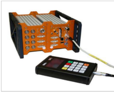
Hình 3. Bộ thu thập và đánh giá dữ liệu DAS-3 Cảm biến S-motion đo vận tốc thân xe
