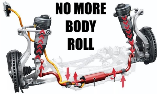
Hình 2. Mô tả nguyên lý hoạt động của hệ thống ổn định ngang chủ động
