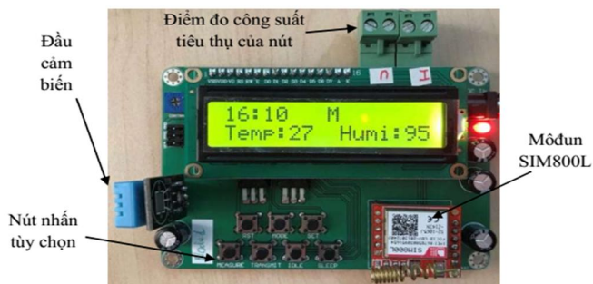
Hình 5. Hình ảnh thực nút cảm biến đo nhiệt độ và độ ẩm
