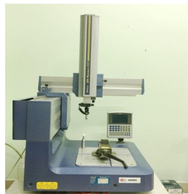
Hình 4. Máy đo 3 chiều Mitutoyo QM333
