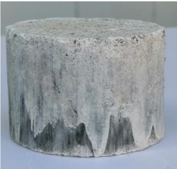
Hình 3. Mẫu vật liệu CX 501 bị "mốc cacbonat"
