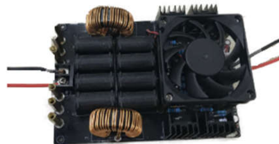
Hình 2. Mạch biến tần cung cấp điện cao tần cho cuộn dây
