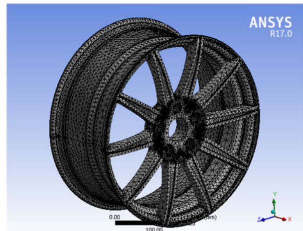
Hình 13. Mô hình phần tử hữu hạn vành ô tô
