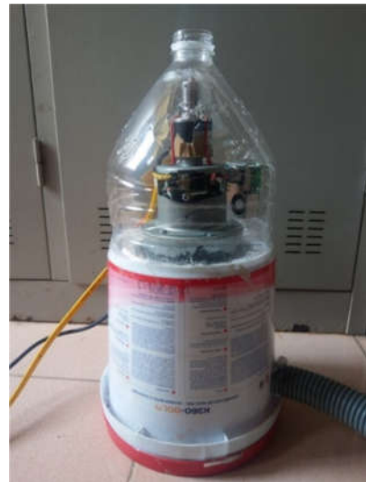
Hình 13. Phần động cơ và khoang hút
