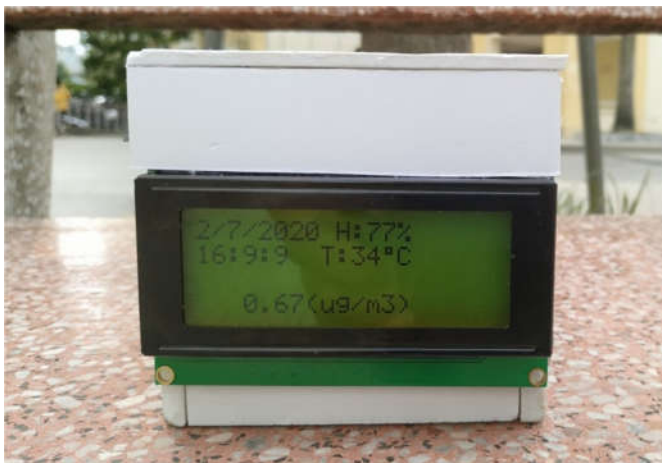
Hình 6. Hệ thống đo chất lượng không khí ngoài trời
