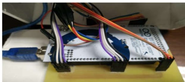
Hình 4. Mạch điều khiển sau khi hoàn thiện
