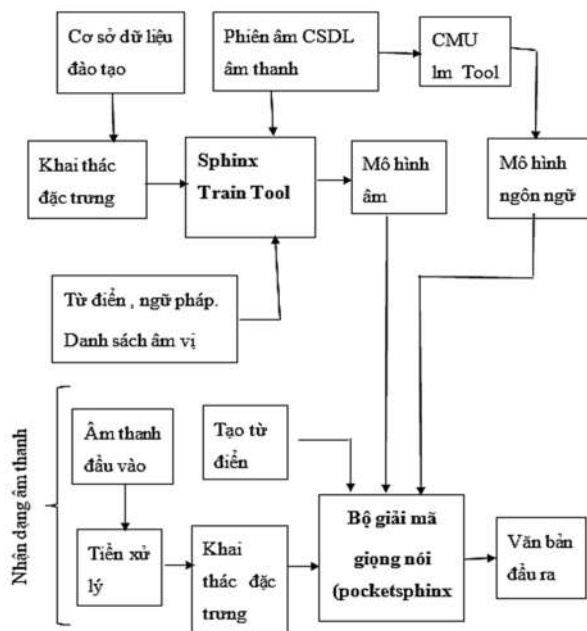
Hình 4. Sơ đồ khối nhận dạng giọng nói với pocketsphinx [4]
