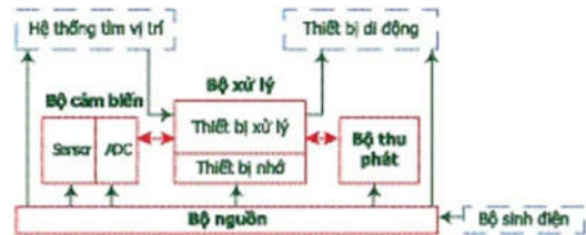
Hình 2. Các thành phần của node cảm biến [3]
