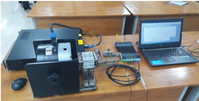
Hình 7. Sơ đồ kiểm tra tần số rung của phôi trên đồ gá
