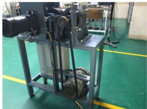
Hình 10. Lắp dây đai và căn chỉnh mô hình
