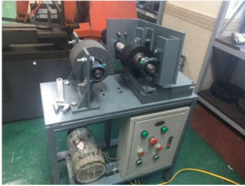
Hình 8. Lắp cụm đá dẫn
