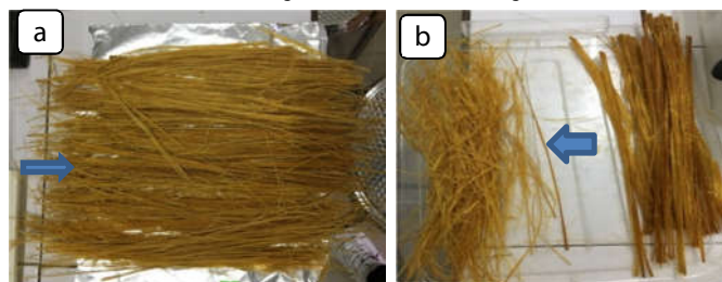
Hình 3. Sợi tre sau khi ngâm xút 5% trong 72h (a); sau khi trung hòa xút dư (b)
