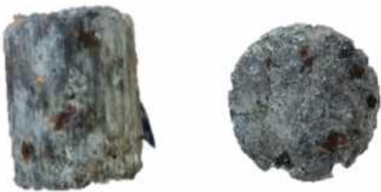
Hình 6. Mẫu gạch được đóng rắn từ tro bay với cao lanh, vôi
