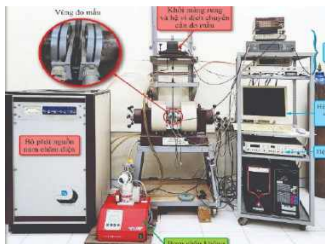
Hình 6. Hệ thiết bị từ kế mẫu rung đo đặc tính từ tính của vật liệu
